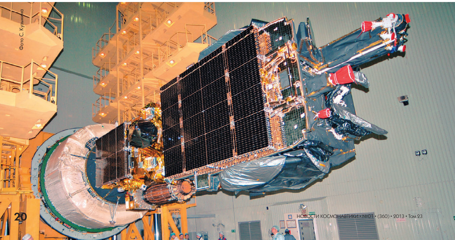
▼ Завершающий этап сборки головной части: РБ «Бриз-М», «Луч-5Б» и «Ямал-300К»
