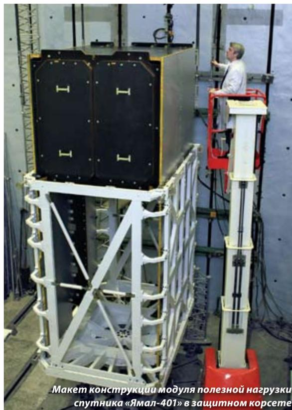
*Макет конструкции модуля полезной нагрузки спутника «Ямал-401» в защитном корсете*
