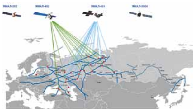
Рис. 4. Предлагаемая схема использования спутниковых каналов для ЕВСПД ПАО «Газпром»
