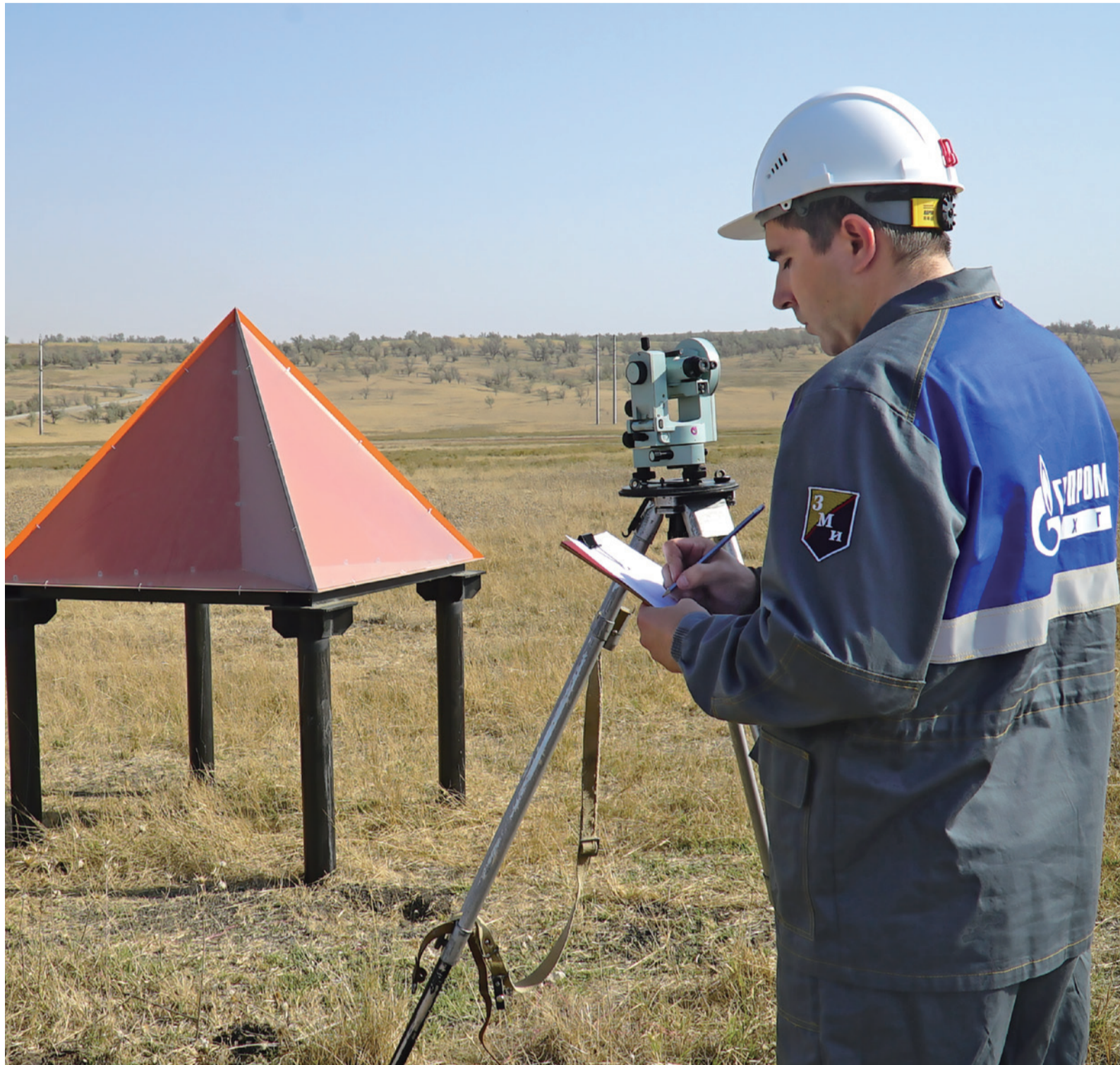
Классические нивелиры постепенно уходят в прошлое. На смену им для выполнения геодезических наблюдений приходят космические технологии. А конструкция пирамидальной формы – не что иное, как угловой отражатель, ключевой элемент наблюдательной сети нового типа
