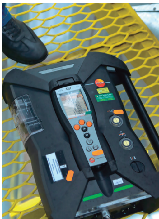
Так происходила фиксация данных во время работы системы селективного каталитического восстановления оксидов азота отходящих газов ГПА
