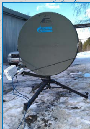
Перевозимый комплекс видеоконференцсвязи, скорость до 8 Мбит/с
