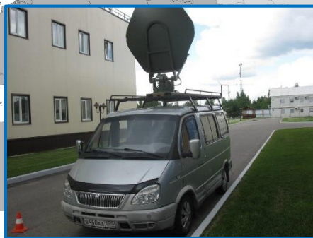
Автомобильный комплекс для работы на стоянке, скорость до 10 Мбит/с
