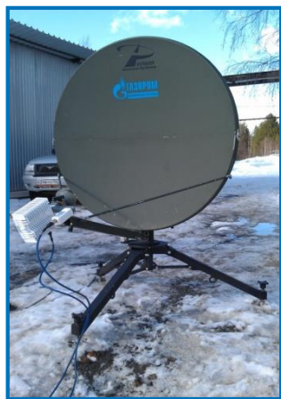
Перевозимый комплекс видеоконференцсвязи, скорость до 8 Мбит/с
