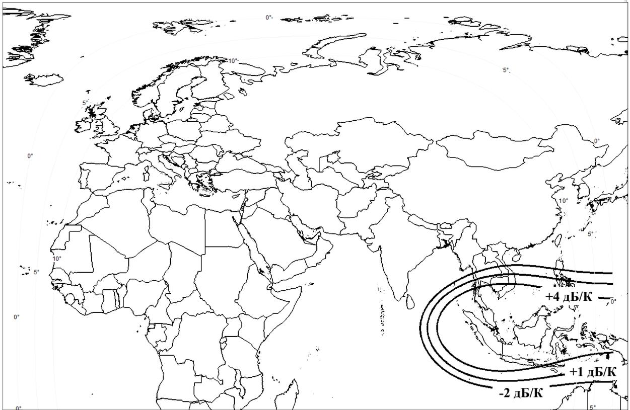
Рис. 2.5. Зона обслуживания (возможное положение) Перецеливаемого луча на прием (значения G/T)
