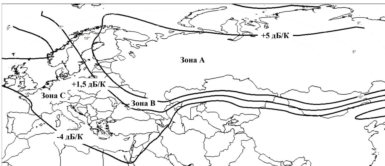
Рис. 2.2. Зона обслуживания Северного луча на прием (значения G/T)
