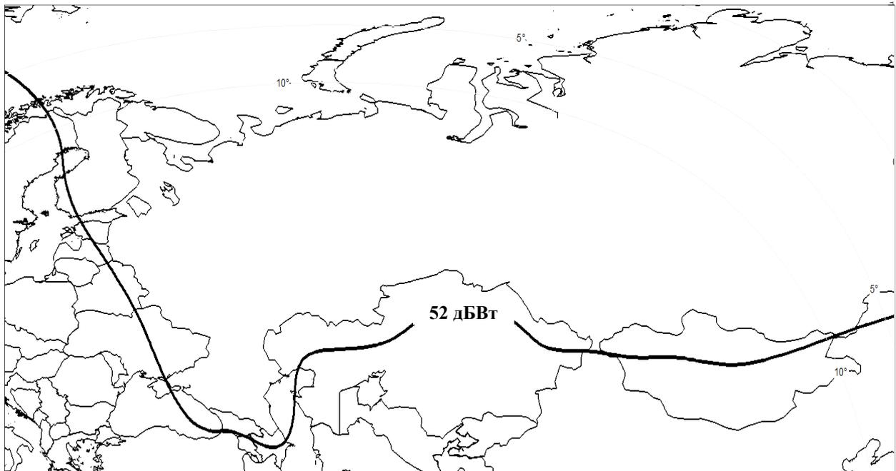
Рис. 2.6. Зона обслуживания Российского луча на передачу (значения эквивалентной изотропно-излучаемой мощности - ЭИИМ)
