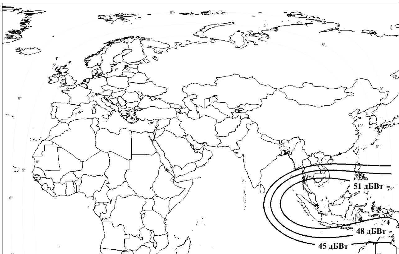
Рис. 2.10 Зона обслуживания (возможное положение) Перенацеливаемого луча на передачу (значения ЭИИМ)
