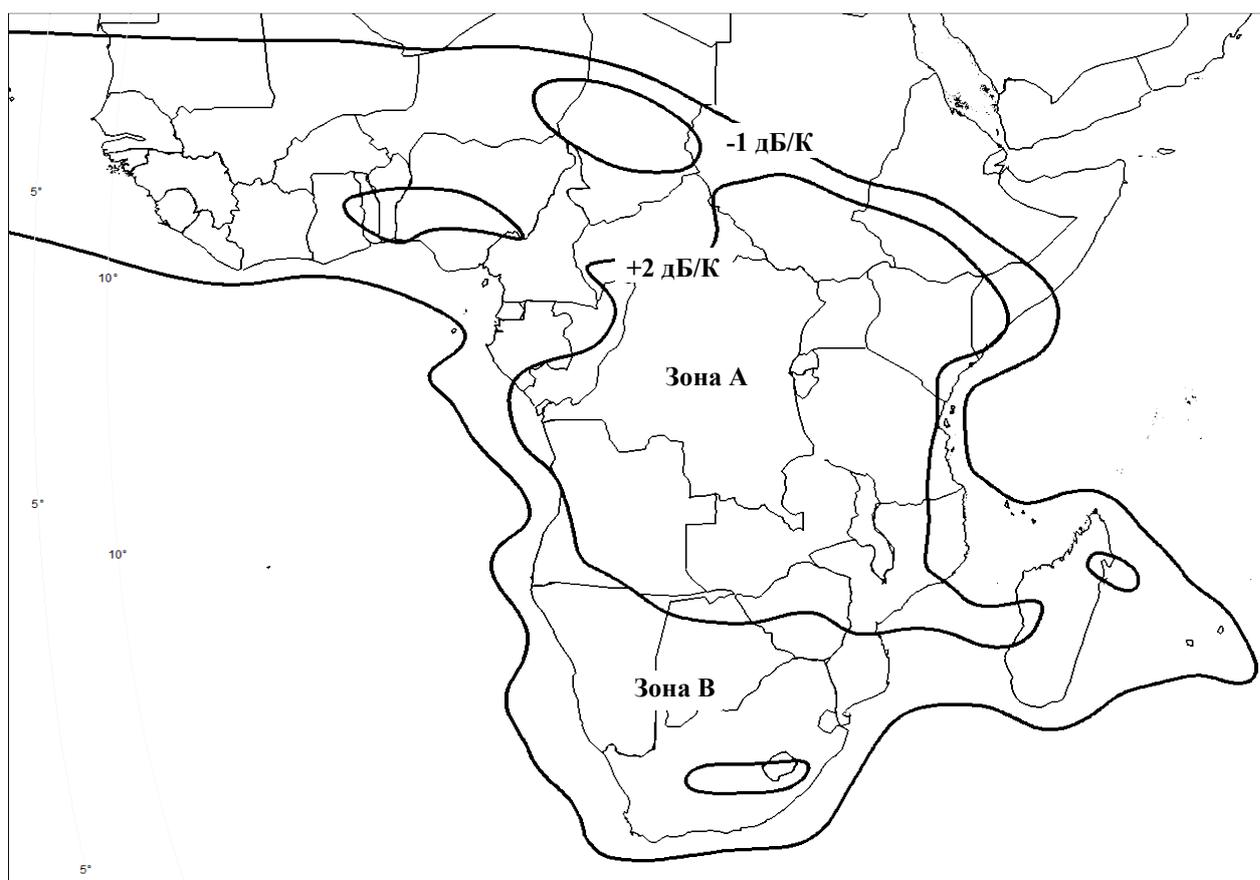
Рис. 2.4. Зона обслуживания Южного луча на прием (значения G/T)
