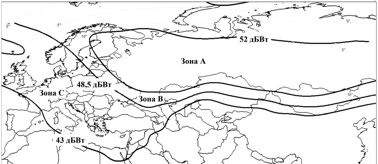
Рис. 2.7. Зона обслуживания Северного луча на передачу (значения ЭИИМ)
