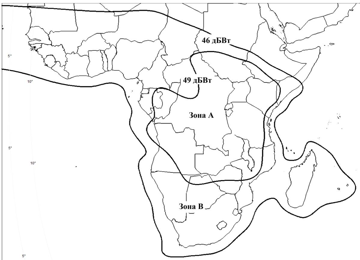
Рис. 2.9. Зона обслуживания Южного луча на передачу (значения ЭИИМ)
