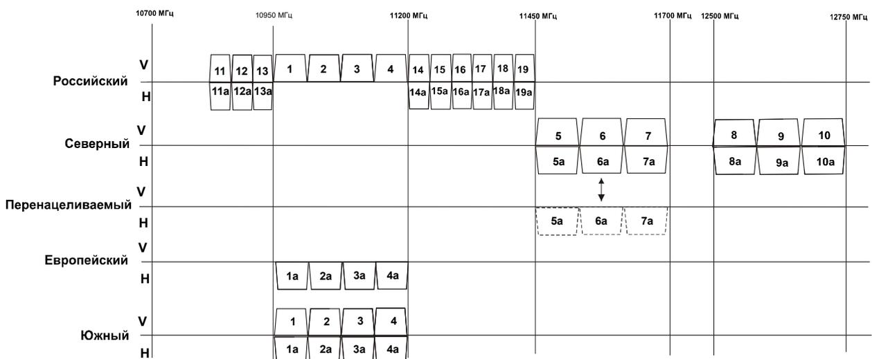
Рис. 2.11. Частотно-поляризационный план транспондеров
